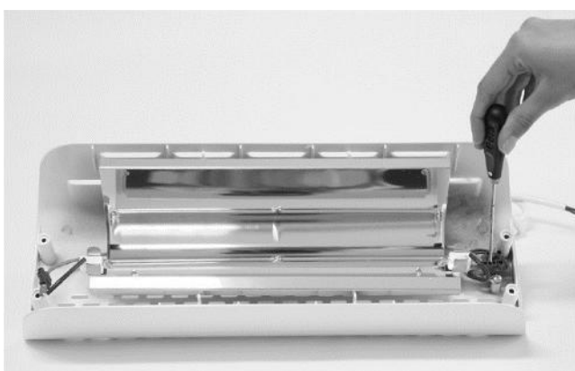
3. TOGLIERE IL CORPO ANTERIORE DELL'APPARECCHIO. SVITARE LE VITI DEI MORSETTI A CUI SONO COLLEGATI I DUE CAVI DEL BULBO.
