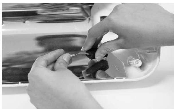
6. CONECTAR LOS FASTON MACHOS DE LA NUEVA BOMBILLA CON LOS DE LOS DOS CABLES, REVESTIRLOS CON LAS CÁPSULAS ELASTOTÉRMICAS Y VOLVER A COLOCAR LA BOMBILLA EN LA SEDE DE LOS RESORTES.
