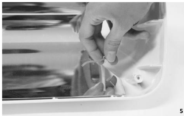
5. IBEI VERSCHLEISS NEUE DICHUNGEN ANBRINGEN, DIE KABEL 5-6 mm ABISOLIEREN, DIE NEUEN FLACHSTECKER ANBRINGEN UND AM KABEL BEFESTIGEN. STREIFEN SIE DAS KABEL 5-6 MM. DIE NEUEN FLACHSTECKER ANBRINGEN UND AM KABEL BEFESTIGEN. DIE LAMPE NICHT MIT BLOSSEN HÄNDEN ANFASSEN.
