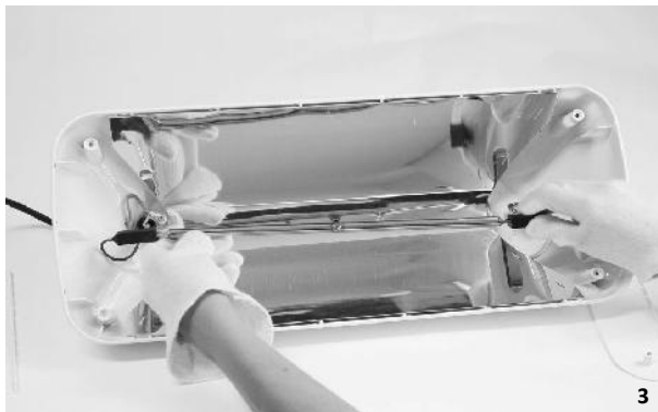
3. EXTRAIRE L'AMPOULE DES CLIPS.
