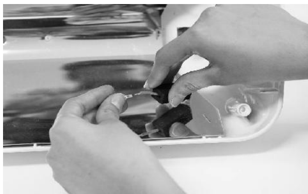
6. DIE FLACHSTECKER DER NEUEN LAMPE MIT JENEN DER BEIDEN KABEL VERBINDEN, DIE DICHUNGEN ÜBERZIEHEN UND DIE LAMPE IN DEN SITZ DER BEIDEN FEDERN EINSETZEN.
