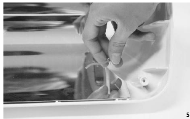
5. INFILARE LE CAPSULE ELASTOTERMICHE DI SCORTA AL POSTO DI QUELLE RIMOSSE, SPELARE I CAVI PER 5/6 mm, INFILARE I NUOVI FASTON DI SCORTA E SCHIACCIARLI SULLA PARTE SPELATA DEI CAVI. FARE ATTENZIONE A NON TOCCARE IL BULBO A MANI NUDE.
