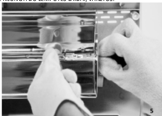
5. ĮSTATYKITE NAUJĄ LEMPUTĘ Į SPYRUOKLINIUS SPAUSTUKUS, SUTRUMPINTUS JOS LAIDUS REIKĖS ĮSTATYTI Į GNYBTUS. VĖL SURINKITE PRIETAISĄ ATLIKdami PIRMIAU NURODYTUS VEIKSMUS ATVIRKŠČIA TVARKA.
