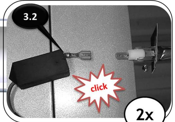
**ITALIANO** - Sfilare le due capsule siliconiche che coprono la fine del bulbo e disconnettere i due faston. Inserire il nuovo bulbo facendo l'operazione inversa avendo cura di non toccarlo a mani nude. Per chiudere V304 ripetere l'operazione in maniera inversa.
