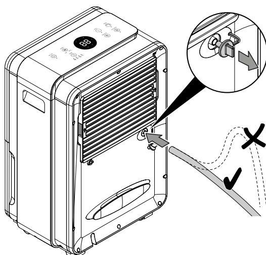
3. Kitą žarnos galą nuveskite iki tam pritaikytos išleidimo vietas (pavyzdžiui, kanalizacijos grindyse). Užtikrinkite, kad žarna nebūtų užsilenkusi.
